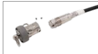
Húzza át a kötelet az ékek közepén, majd hajtogassa ki a kötélzárlakat az ékekre ezután csatlakoztassa a terminálba.
